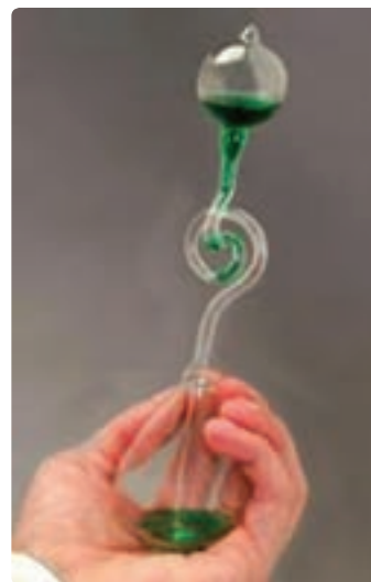
شکل ۴-۴۳ با دست گرفتن حباب شیشه‌ای و گرم کردن آن، مایع رنگی در لوله ماریچ بالا می‌رود.
