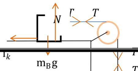
۱۱. دو وزنه A و B به جرم های  $10\text{ kg}$  و  $8\text{ kg}$  مطابق شکل توسط ریسمان بدون جرمی به هم وصل شده اند. اگر ضریب اصطکاک جنبشی در کلیه سطوح  $0.2$  باشد، شتاب حرکت وزنه ها و نیروی کشش نخ را به دست آورید.
