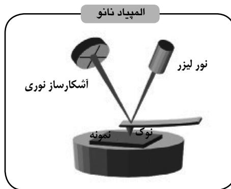
شکل ۱۱ : روش کار نانوسکوپ
